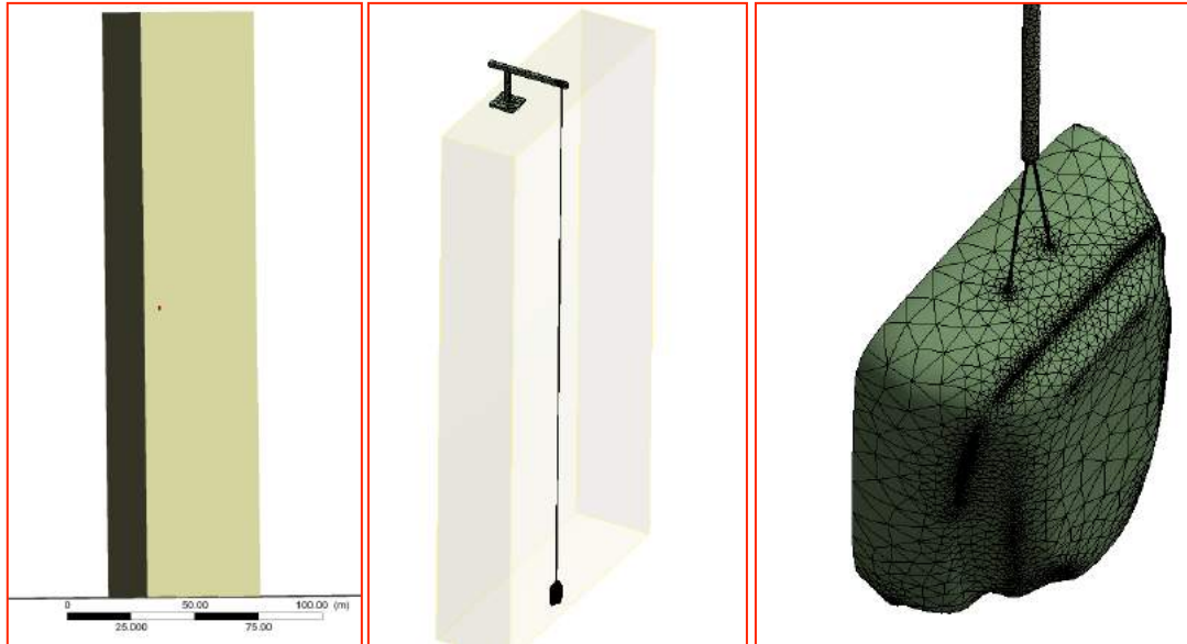
Şekil 6. Cihazın binaya bağlanma görüntüleri ve düğüm yapıları
