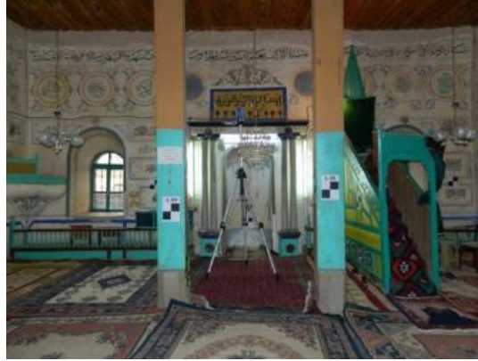
Resim 11. Bademli Köyü Camisi'nin Yersel Lazer Yöntemi İle Ölçümü
