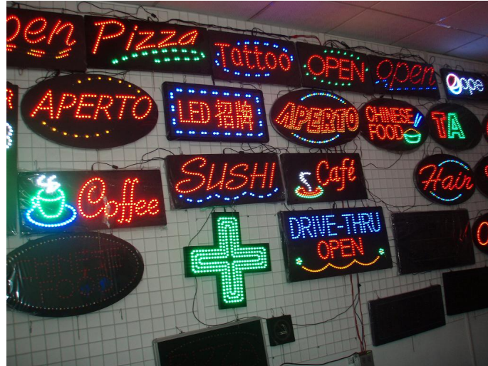
Resim 3. Kırmızı Led Dalga Boyu 625- 630 nm. piksel yoğunluğu 10.000 piksel/ m2, parlaklığı 2500 CD/ m2 LED tabela örnekleri.
